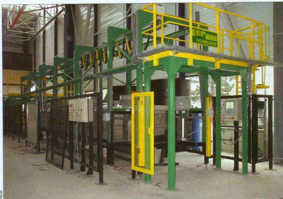
Chaîne de contrôle automatique pour pièces automobiles.
