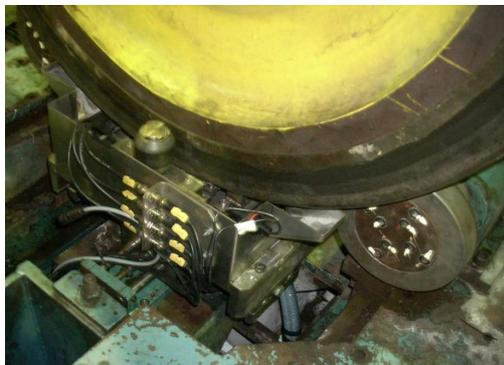
Contrôle de la roue par Immersion dans un bac à eau
