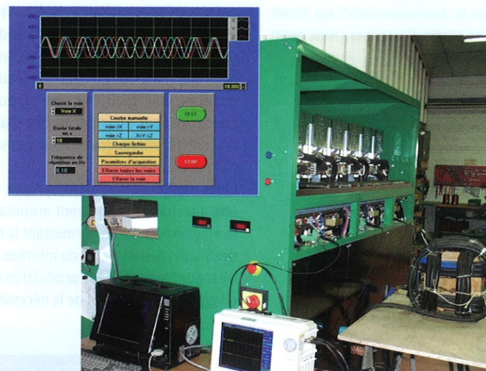
FIGURE 14 : Optimisation de la fréquence pour détecter certains types de défaut.
