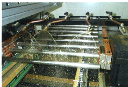
FIGURE 12 : Contrôle de crémaillères - aimantation par champ tournant sur banc.
